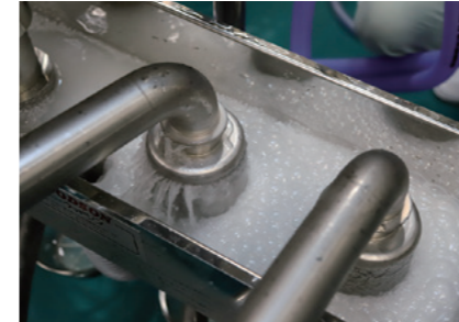
ジェット式気泡を利用した洗米の様子
